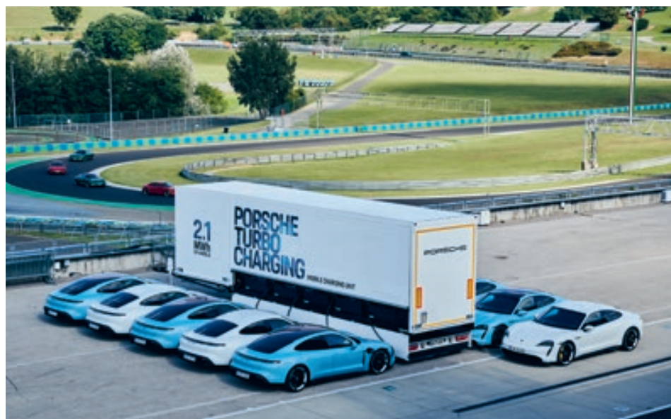
Bis zu zehn Taycan können im Parallelbetrieb mit jeweils bis zu 320 Kilowatt Leistung am Ladetruck geladen werden.
